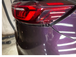
Tampon, arka, Arka tampon > Sabitlemesi Hatalı
