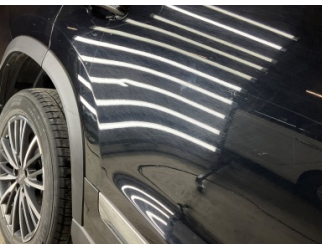
Kapı, sağ arka, Kapı, sağ arka > Ezik
