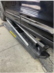
Marşbiyel, sol, Marşbiyel, sol > Hasarlı
