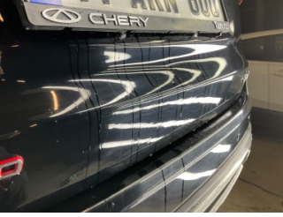
Bagaj kapağı/kapısı, Bagaj kapısı > Standart Dışı Onarım
