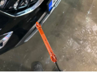
Motor, Yağ seviyesi > Eksik
