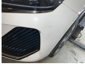
Tampon, ön, Ön tampon > Çatlak
