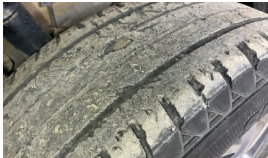
Lastik, ön > Hasarlı
