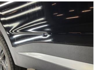
Kapı, sağ arka, Kapı, sağ arka > Vuruk
