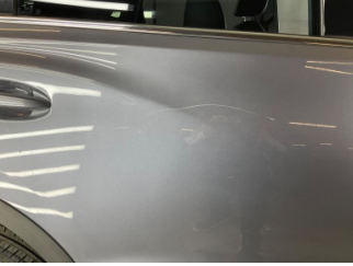
Kapı, sağ arka, Kapı, sağ arka > Çizik
