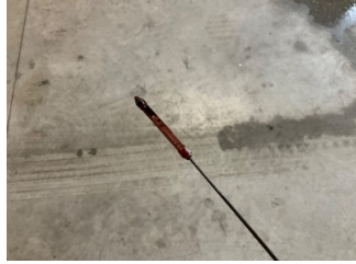
Motor, Yağ seviyesi > Eksik
