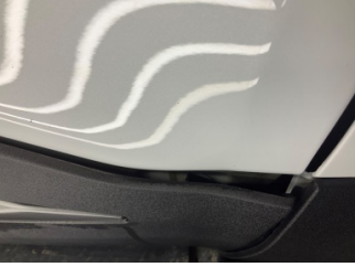
Kapı, sağ ön, Kapı bandı > Sabitlemesi Hatalı
