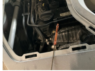
Motor, Yağ seviyesi > Eksik
