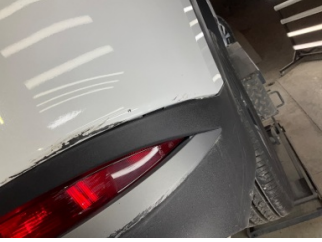
Tampon, arka, Spoyler > Sabitlemesi Hatalı
