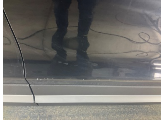
Kapı, sağ ön, Kapı, sağ > Çizik
