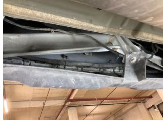
Tampon, arka, Bağlantı ayağı > Hasarlı
