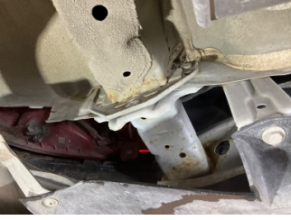
Kaporta, Sağ Arka Şase > Hasarlı
