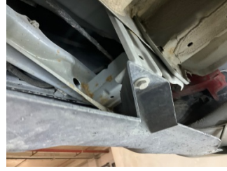
Tampon, arka, Bağlantı ayağı > Hasarlı
