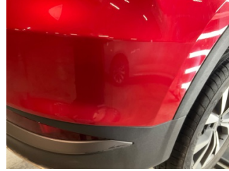
Tampon, arka, Arka tampon > Küçük Çizik
