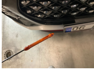
Motor, Yağ seviyesi > Eksik
