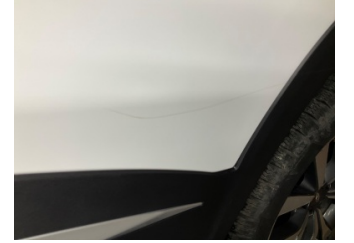
Kapı, sol arka, Kapı, sol arka > Çizik
