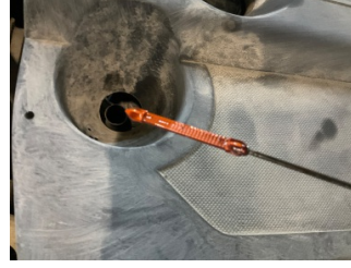
Motor, Yağ seviyesi > Eksik
