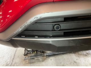
Tampon, ön, Ön tampon ızgarası > Sabitlemesi Hatalı
