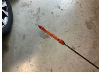
Motor, Yağ seviyesi > Eksik
