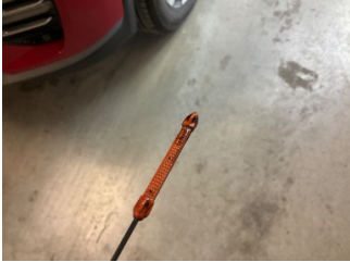
Motor, Yağ seviyesi > Eksik
