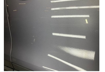
Kapı, sağ ön, Kapı, sağ ön > Çizik
