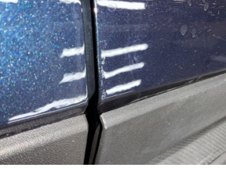
Kapı, sağ ön, Kapı, sağ ön > Çizik
