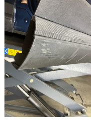
Kapı, sağ ön, Kapı bandı > Çizik
