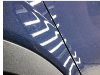
Çamurluk, sol, Çamurluk, sol > Küçük Çizik
