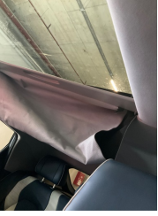
Tavan, Sunroof ilave parçalar/sabitleyici > Hasarlı
