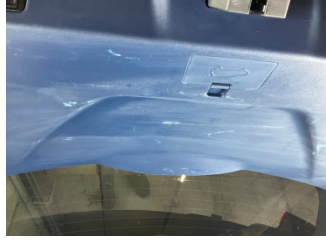
Döşemeler/Kapaklar, Döşemeler/Kapaklar > Deforme Olmuş
