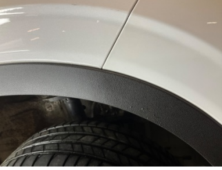
Çamurluk, sağ, Çamurluk, sağ > Yüzeysel Çizik
