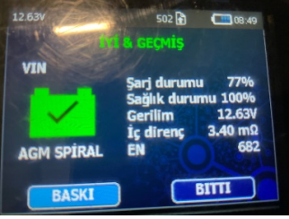
Elektrik donanımı/Pano, Akü > Test Sonucu
