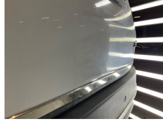
Bagaj kapağı/kapısı, Bagaj kapısı > Deforme Olmuş
