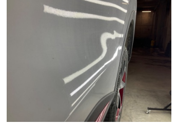
Kapı, sol arka, Kapı, sol arka > Standart Dışı Onarım
