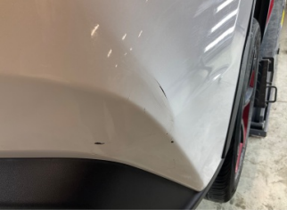
Tampon, arka, Arka tampon > Çatlak
