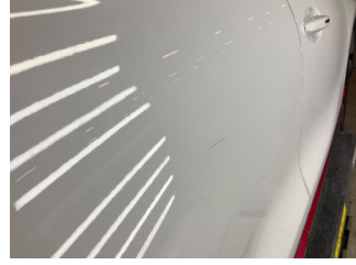
Kapı, sağ arka, Kapı, sağ arka > Çizik
