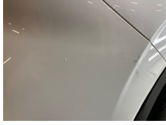
Tampon, arka, Arka tampon > Çatlak
