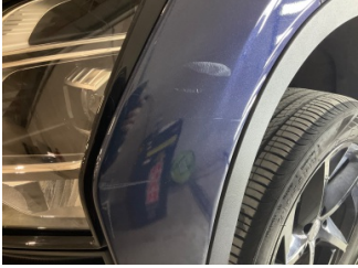
Tampon, ön, Ön tampon > Yüzeysel Çizik
