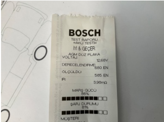
Elektrik donanımı/Pano, Akü > Test Sonucu
