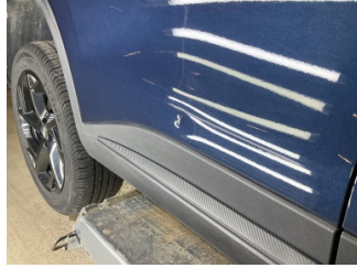
Kapı, sağ arka, Kapı, sağ arka > Ezik
