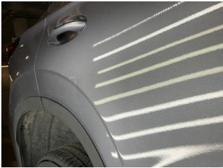
Kapı, sağ arka, Kapı, sağ arka > Ezik
