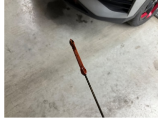
Motor, Yağ seviyesi > Eksik
