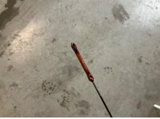
Motor, Yağ seviyesi > Eksik
