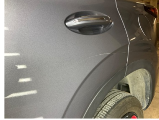
Kapı, sol arka, Kapı, sol arka > Çizik
