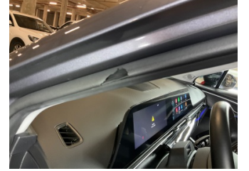
Kapı, sol ön, Kapı fitili > Hasarlı
