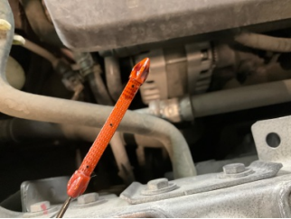
Motor, Yağ seviyesi > Eksik
