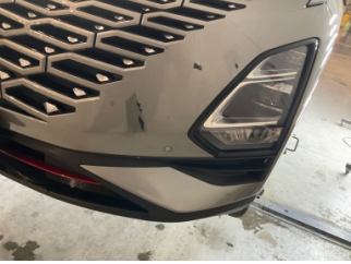
Tampon, ön, Ön tampon > Boyası Atmış
