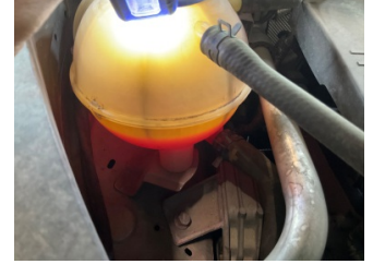
Motorsoğutması, Soğutma sıvısı > Eksik
