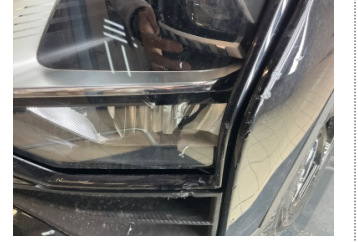
Farlar, Far camı, sol > Hasarlı
