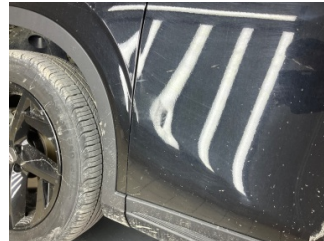
Kapı, sol ön, Kapı, sol ön > Ezik
