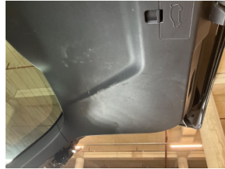
Döşemeler/Kapaklar, Döşemeler/Kapaklar > Yüzeysel Çizik
