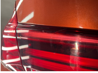
Arka lambalar, Arka lamba camı, sol > Hasarlı
