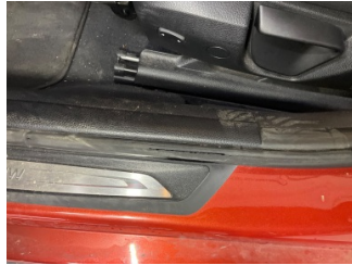
Kapı, sol ön, Kapı fitili > Hasarlı
