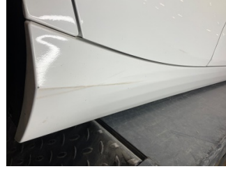
Marşbiyel, sağ, Marşbiyel plastiği, sağ > Yüzeysel Çizik
