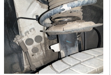
Ön aks, Amortisör, ön sol > Yağ Kaçağı
