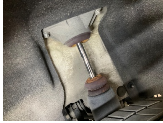
Arka aks, Amortisör körüğü, sol > Hasarlı
