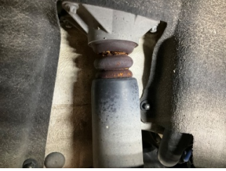
Arka aks, Amortisör körüğü, sağ > Hasarlı
