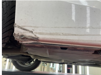
Marşbiyel, sağ, Marşbiyel plastiği, sağ > Hasarlı
