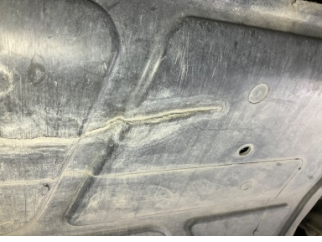
Motor, Alt muhafaza > Kırılmış
