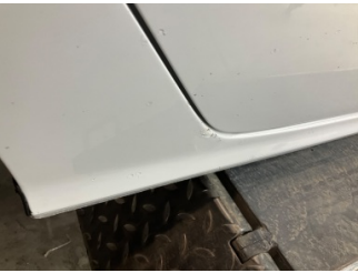
Marşbiyel, sağ, Marşbiyel, sağ > Boyası Atmış
